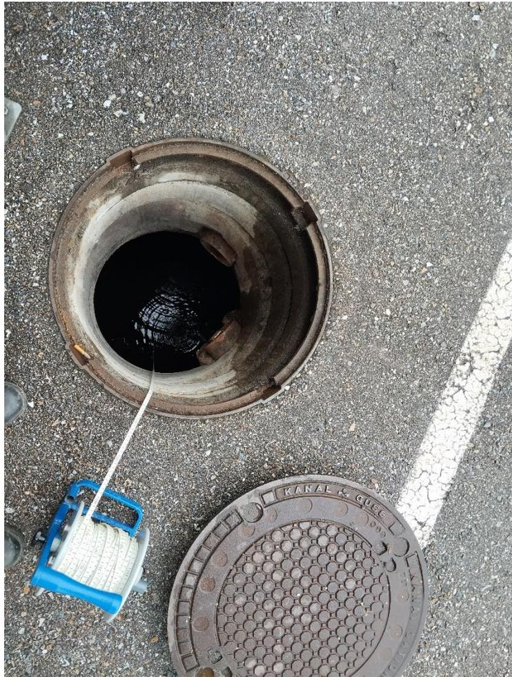
Abbildung 1: Versickerungsversuch VV 01 in bestehendem Sickerschacht
